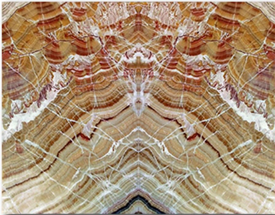
اینگونه سنگها در اثر دگرگونی سنگ آهک به وجود می آید بدنه اصلی تشكیل دهنده این سنگ ها کلسیت است که بسیار در سیستم مجسمه سازی و نقش و نگارهای ساختمانی مورد استفاده قرار میگیرد. خاصیت عبور دهی نور... سطح صاف و صیقلی... تراکم بالا جذب رطوبت و آب پایین و مقاومت سایشی تقریباً مناسب.... در کنار خاصیت عبور دهی نور یکی از ویژگی های منحصر به فرد سنگ مرمر که در تمام دسته های سنگ مرمر یکسان میباشد خاصیت خنک کنندگی این سنگ بوده. اینکه گرمای را جذب نکرده و همیشه خنک می باشد
